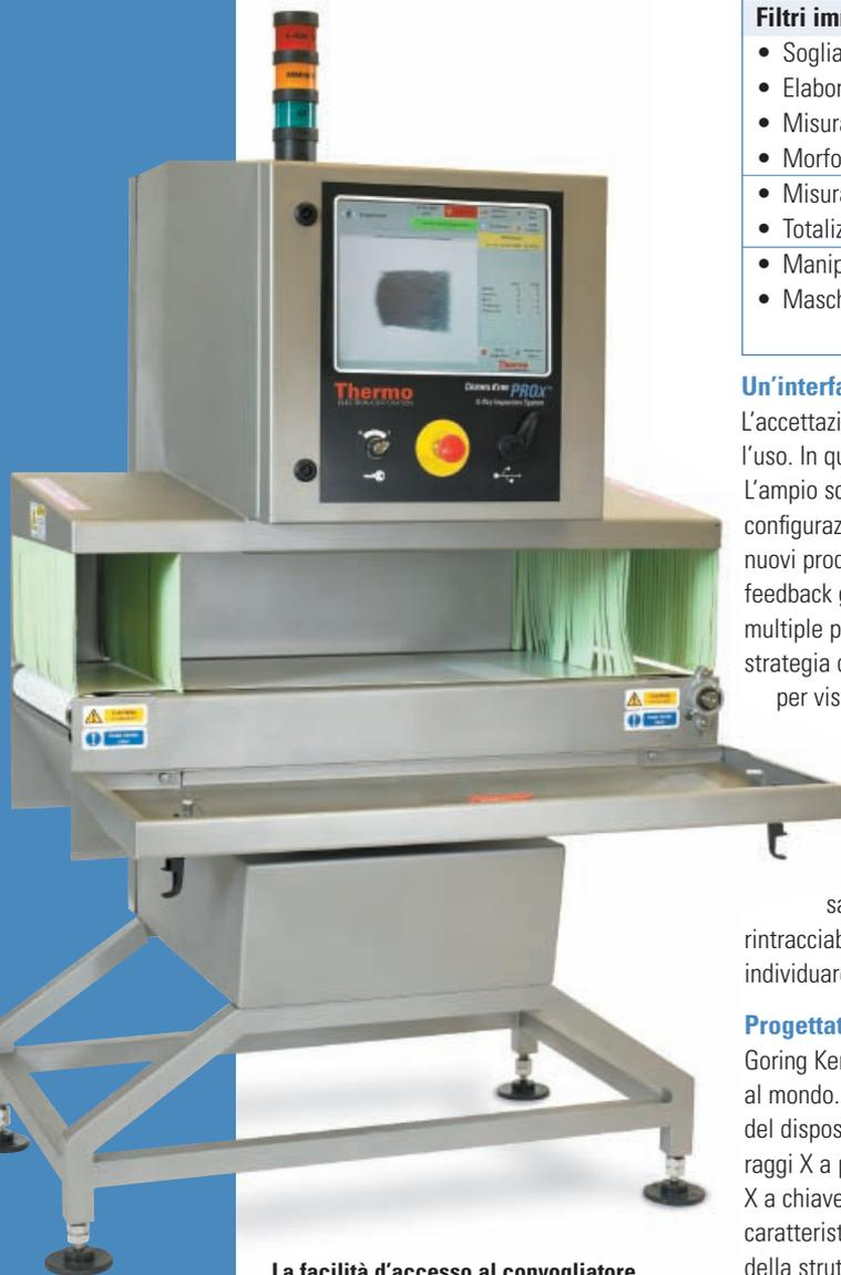
La facilità d'accesso al convogliatore consente una rapida pulizia e sostituzione del nastro.
